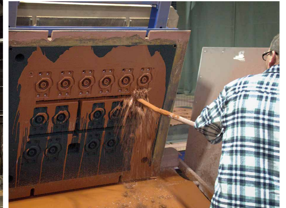
Oben: Nach dem Trennen und Nachhärten der Form wird eine alkoholhaltige Schichte aufgetragen.
