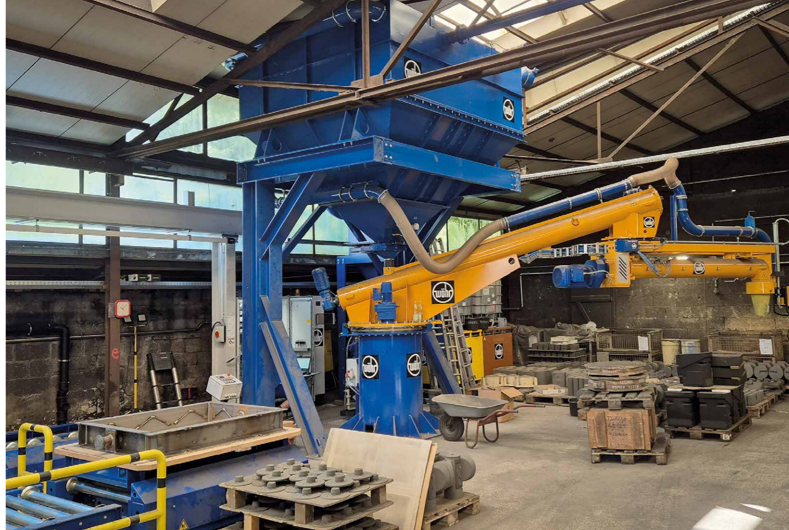
Oben: Der Wöhr-Durchlaufwirbelmischer ist die zentrale Komponente im Bereich des Modellumlauftes.
