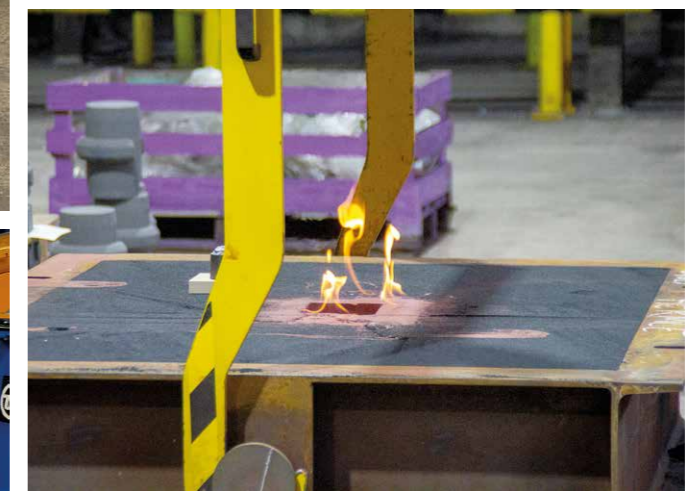
Oben: Nach dem Trennen und Nachhärten der Form wird eine alkoholhaltige Schichte aufgetragen.
